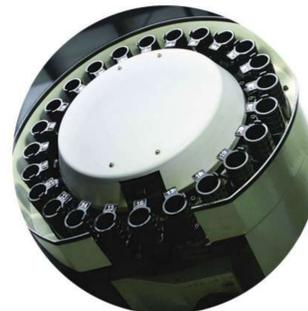
Cambiador de herramientas automático tipo brazo con 24 estaciones. Un sistema flexible y muy productivo con velocidad de 1.8 segundos en tiempo de cambio de herramienta.
