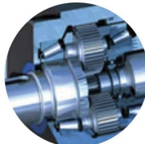
Motor potente de 15hp con gran torque 82Nm adicionado con un retardador marca ZF (Alemania) para 8,000rpm.
