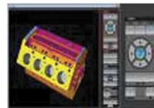
La verificación de gráficos avanzados\* de sólidos en 3D le permite ver la representación exacta de la pieza a maquinar. El software también le ofrece rotación dinámica, alejamiento, acercamiento y trayectoria de herramienta en tiempo real. Adicionalmente, puede asignar colores a herramientas específicas para su fácil identificación. Reduce consistentemente el desperdicio y usted ahorra tiempo en programación.
